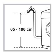
Ligue o tubo de descarga, sem dobrá-lo, a uma conduta de descarga ou a uma descarga na parede situada entre 65 e 100 cm de altura do chão;
